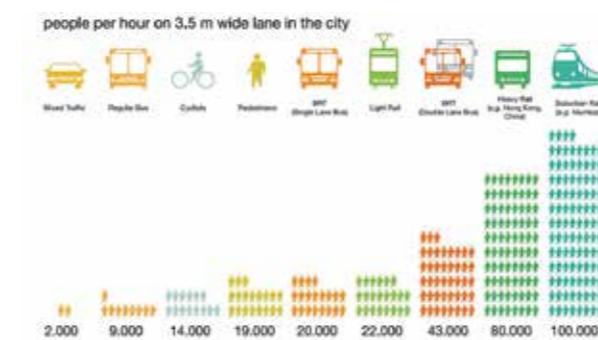
Fig. 6. Inschatting van de verwerkingscapaciteit in aantallen reizigers per rijbaan per modaliteit. (Bron: ADB (2012), Solutions for Urban Transport, Asian Development Bank ( www.adb.org ))
